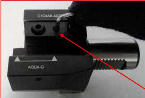
Mittlere Schraube lösen +
