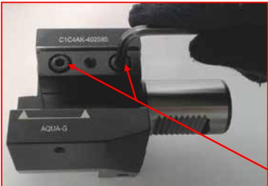
Spannschrauben am Keil lösen
